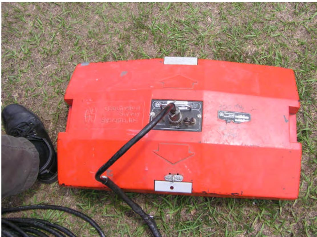
圖3-35 地探雷達之探測設備
