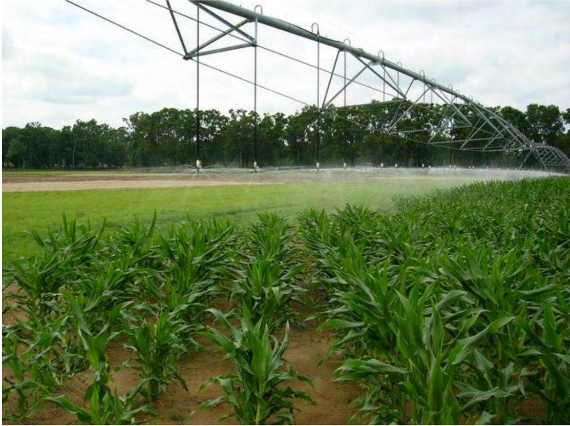
圖3-10 Liner Pivot灑水灌溉
