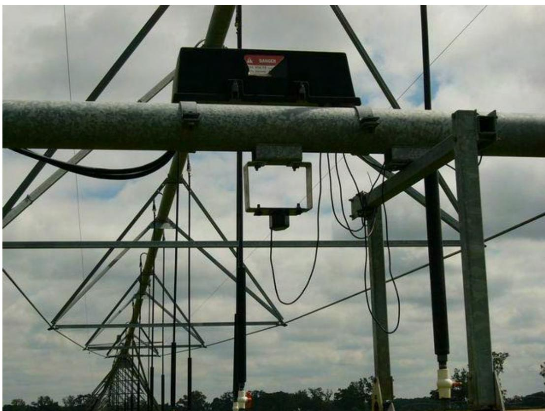
圖3-13 Liner Pivot移動控制天線
