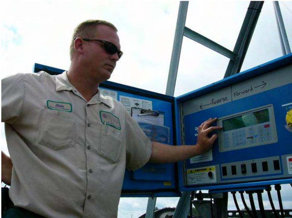
圖3-14 Liner Pivot操作控制箱
