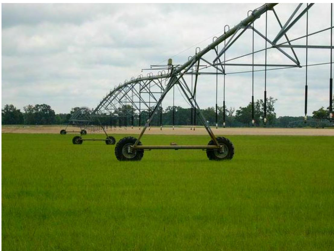
圖3-9 噴灌器具 - Liner Pivot
